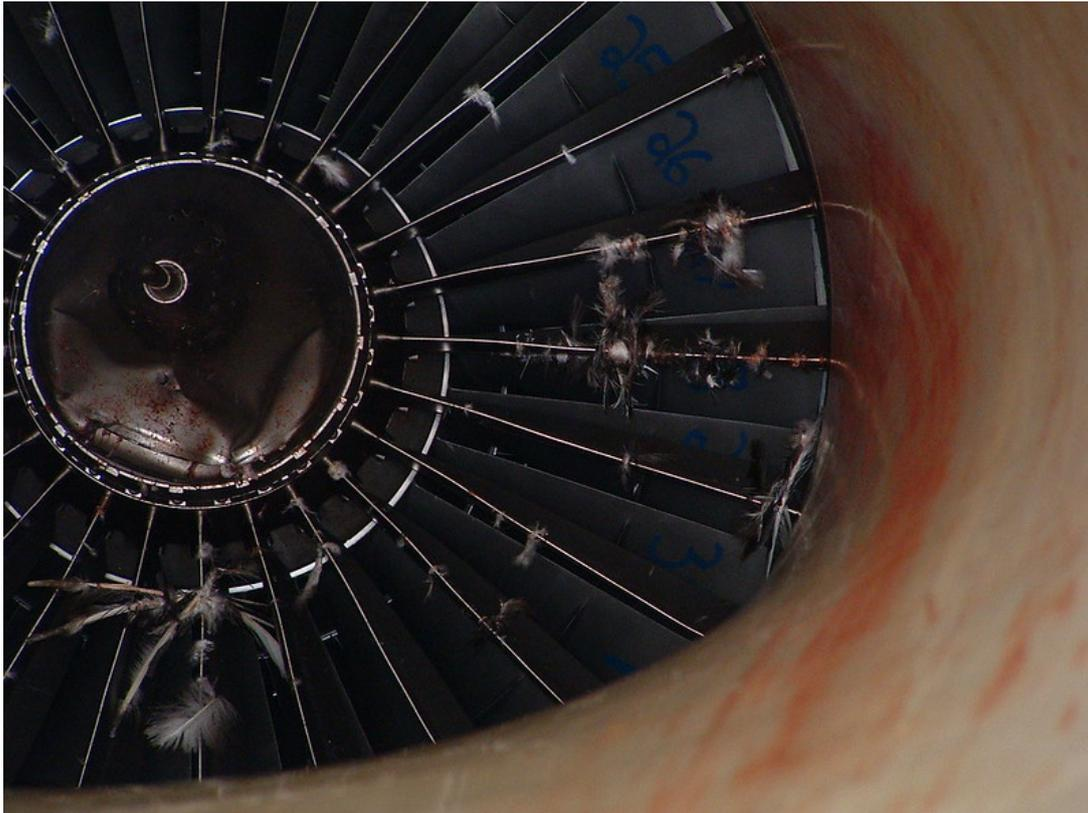
Сегодня столкновение воздушного судна с птицей является одним из наиболее опасных видов авиационного инцидента. Зачастую такие столкновения приводят к повреждению элементов воздушного судна, редко, к катастрофам. Опасность представляет попадание птицы в лопасти турбореактивного двигателя, что может привести к его разрушению.
